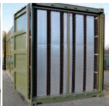
Axialventilatoren sind sparsam im Energieverbrauch (links). Die Geräusche durch die Luftanströmung schlucken in den Luftstrom eingebaute Kulissenschalldämpfer (rechts).
